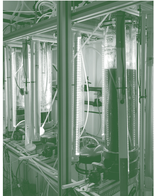
Planta experimental de cultivo de microalgas para la eliminación de nutrientes.
